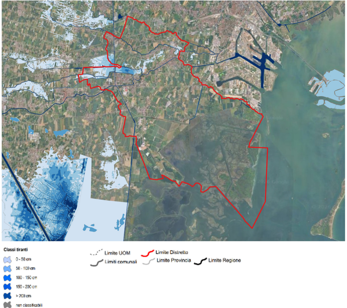
Figura 6.6 - PGRA Distretto Alpi Orientali: Carta delle altezze idriche, scenario di media probabilità – TR 100 anni.
